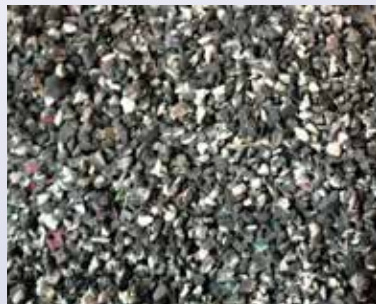
► Résidus plastiques en mélange PE-PER/PVC, taille 2-5 mm
