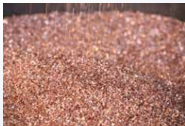
► Résidus métalliques, granulés de cuivre, taille 4-6 mm
